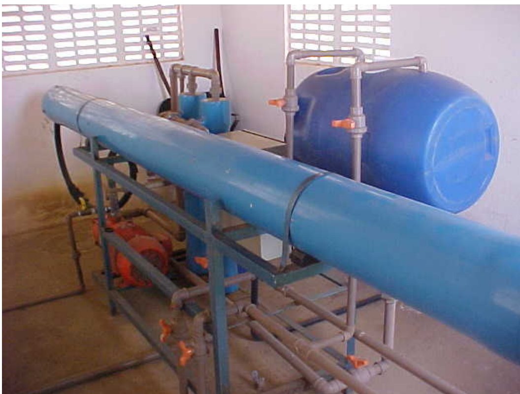
Foto 5.1.20 – Detalhe do Dessalinizador em Operação
